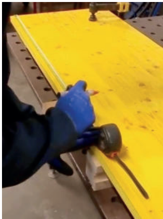
1 Schnittmaße markieren: Montageart A: Eingangsbreite - 43 mm Montageart B: Eingangsbreite - 143 mm Montageart C: Außenabmessungen + 100 mm
